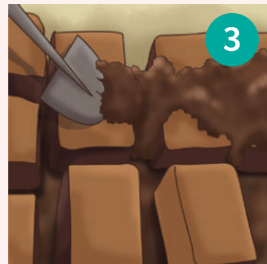
Rellenar los espacios entre los adobes con la mezcla de barro y emparejar.
